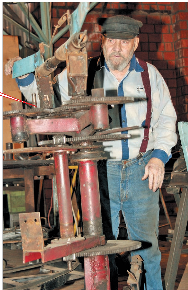
Внутри конструкция проста: тракторные шестерни, металлические трубы и специальные устройства для преобразования тока.
