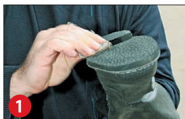
1 Сначала мы зачистили ботинки наждачной бумагой.
