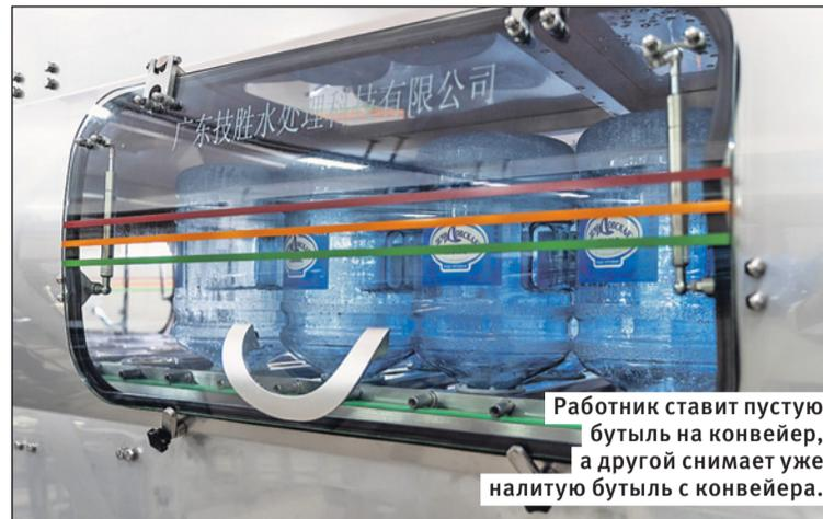
Работник ставит пустую бутылку на конвейер, а другую снимает уже налитую бутылку с конвейера.
