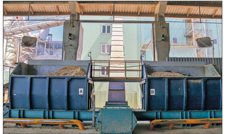
Система подачи щепы в печь. В год можно утилизировать до 40 000 тонн.
