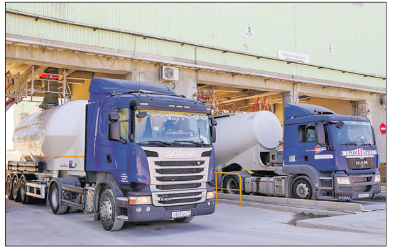
Цемент загружается с помощью рукавов с системой обеспыливания. Машины остаются абсолютно чистыми.
