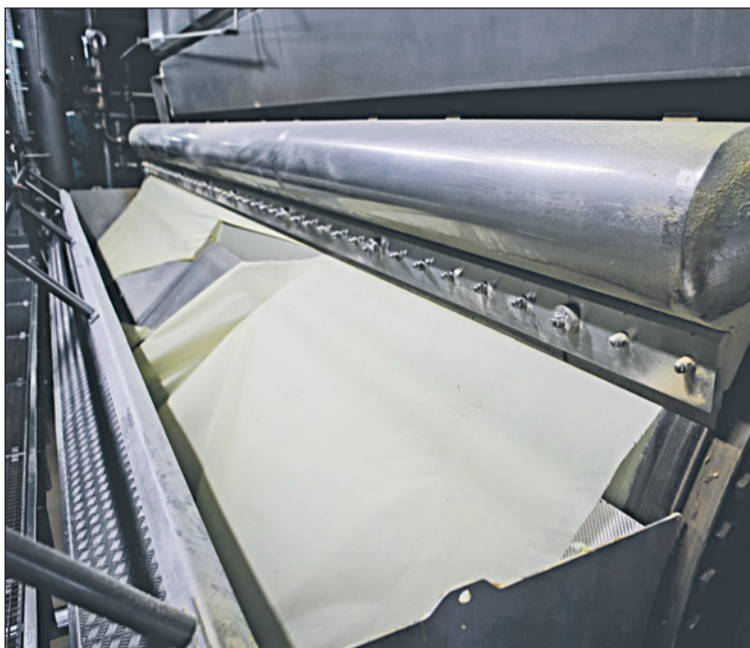
Из сушилки выходят широкие полотна, похожие на тончайшую ткань. После они рвутся и превращаются в хлопья.
