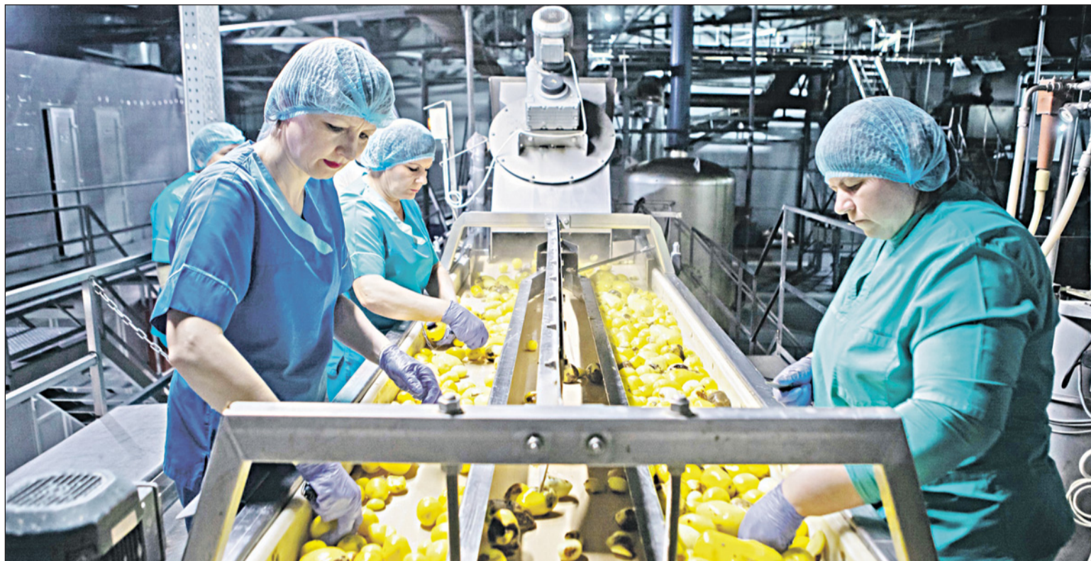
Основной процесс автоматизирован, а вот сортировка очищенного картофеля производится вручную. В бригаде четыре женщины, через их руки проходят все 400 тонн перерабатываемого за день картофеля.
