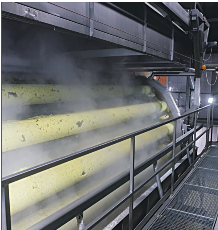
Картофель после варки попадает на вальцы, которые превращают его в пюре.
