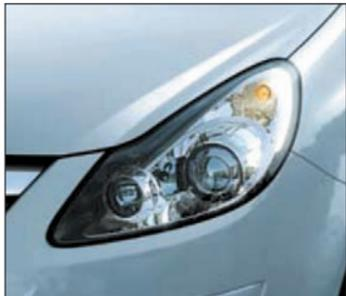
**ЗАГЛЯНИ ЗА ПОВОРОТ.** Corsa оснащена уникальной системой переднего освещения с галогенными фарами. При включении датчика поворота лампы освещают правую или левую часть дороги — в направлении поворота. На высокой скорости фары могут поворачиваться на 15 град!
