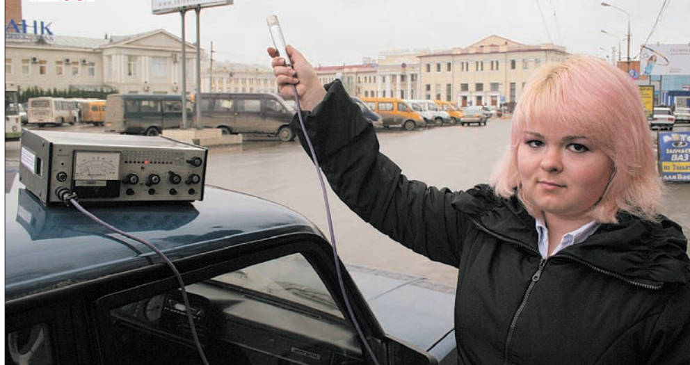
Прибор для измерения шума от транспорта, похожий на обыкновенный микрофон, зафиксировал превышение допустимого уровня.
