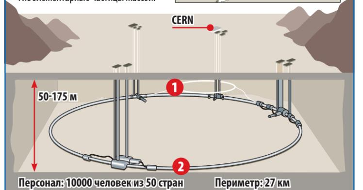
**1** На «малое кольцо» коллайдера запускается сначала один, а потом другой пучок протонов для достижения ими начального ускорения.
