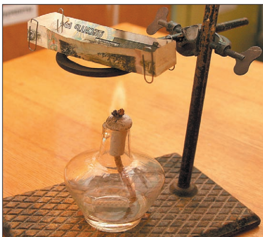
Свернутый червонец с водой мы закрепили над зажженной спиртовой горелкой...
