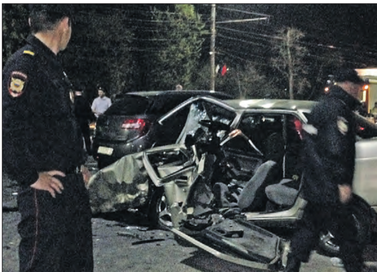
На фото ВАЗ-2110 после извлечения из него пострадавших. Корпус машины пришлось разрезать гидравлическими ножницами и кусачками.
