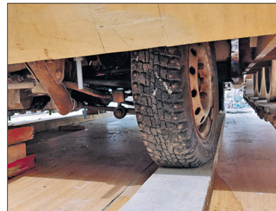
Танк ездит на автомобильных колесах, так как деревянные гусеницы для этого не подходят.
