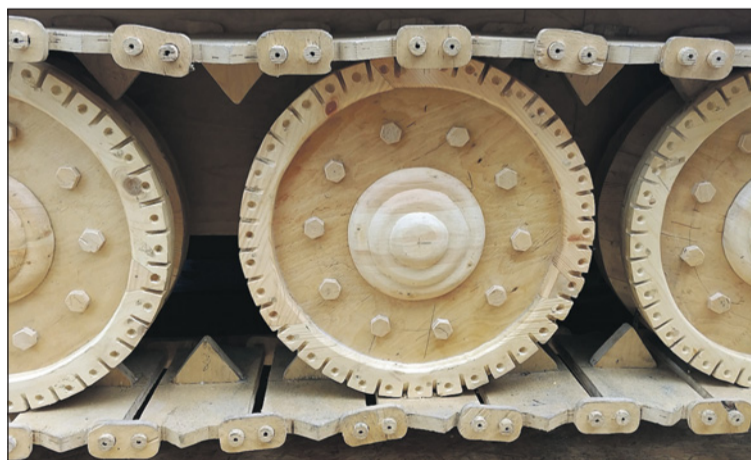
Одним из самых трудоемких и сложных в изготовлении элементов деревянного танка оказались катки и гусеницы.
