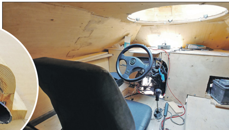
Внутри не слишком просторно – здесь находятся двигатель, элементы управления, система выхлопа и место водителя.
