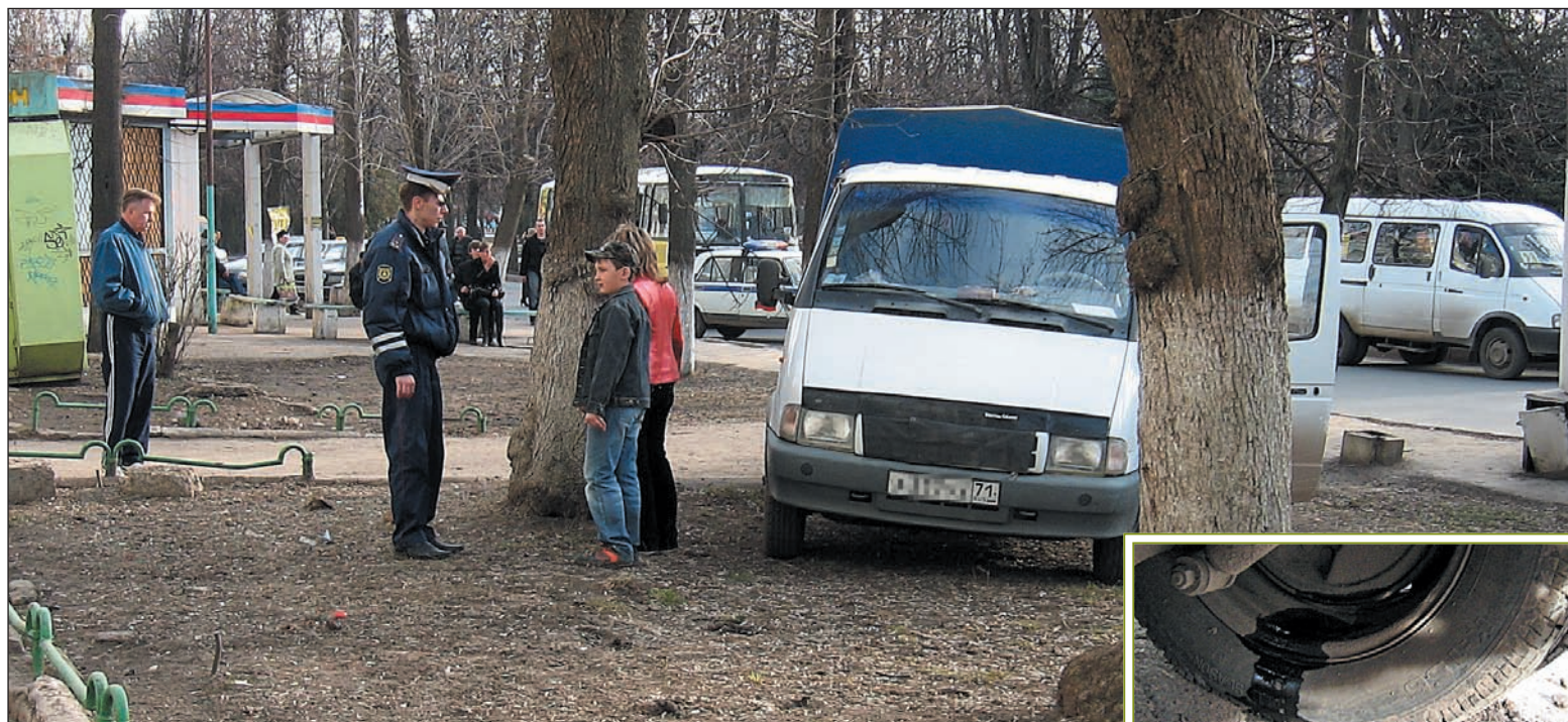
31 марта 2008 г., 17.15. Новомосковск, ул. Московская, 28. По предварительной версии, водитель «Газели» не мог остановиться: из рабочего цилиндра колеса вытекла жидкость, и тормоза отказали.
