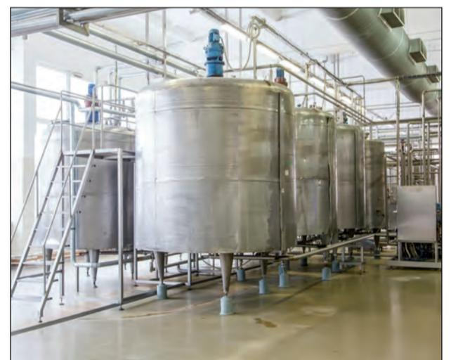
Огромным аппаратным отделением управляют три оператора. Процесс закрытый, молоко по трубам поступает в резервуары в соответствии с заданной программой. Мойка также автоматическая.
