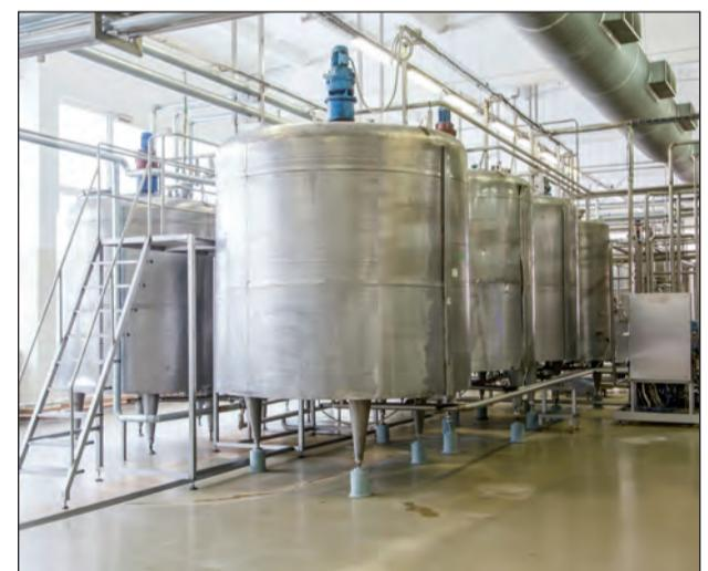
Огромным аппаратным отделением управляют три оператора. Процесс закрытый, молоко по трубам поступает в резервуары в соответствии с заданной программой. Мойка также автоматическая.
