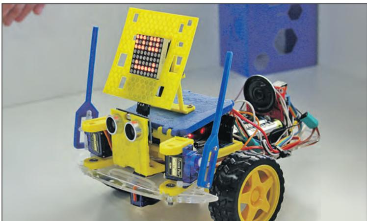
Образовательный робот «Квадроштек» знакомит с базовыми навыками в области робототехники, программирования и 3D-печати.
