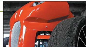
**ОБВЕС.** Корпус был целиком изготовлен вручную из стекловолокна и полимерной смолы, а затем выкрашен в оранжевый цвет.
