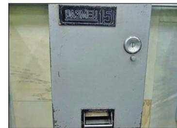
► **Автомат для размена монет.** Стандартный разменный автомат на 15 копеек выдавал набор из двух пятикопеечных монет (цена двух поездок в метро), 3 копейки (цена стакана газировки с сиропом) и 2 копейки (цена звонка из таксофона). Был автомат для размена 10 копеек на три трехкопеечные и однокопеечную монету. В девяностые эти автоматы сменились более современными – для продажи жетонов на проезд в метрополитене.
