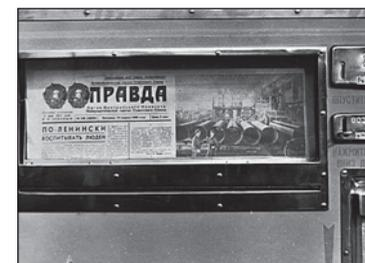
► **Автомат для продажи газет.** Чаще всего он был механическим – монетка, опущенная в монетоприемник, приводила в движение рычажок, который «подавал» газету.
