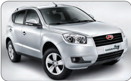
Geely Emgrand X7 Двигатель: 2,0 л 139 л. с., 2,4 л 158 л. с. КПП: 5-ст. «механика»/6-ст. «автомат». Расход топлива: от 8,6 л/100 км. Клиренс: 185 мм.
