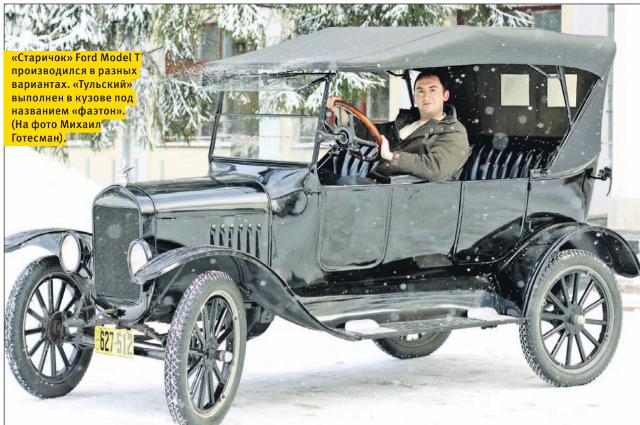
Трудно поверить, что спустя столько лет двигатель работает как часы! Объем – 2,9 л, мощность – 20 л/с. Максимальная скорость авто – 65 км/ч.
