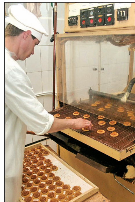
На этой операции рабочий только укладывает печенье на транспортер, а глазировка шоколадом осуществляется автоматически.
