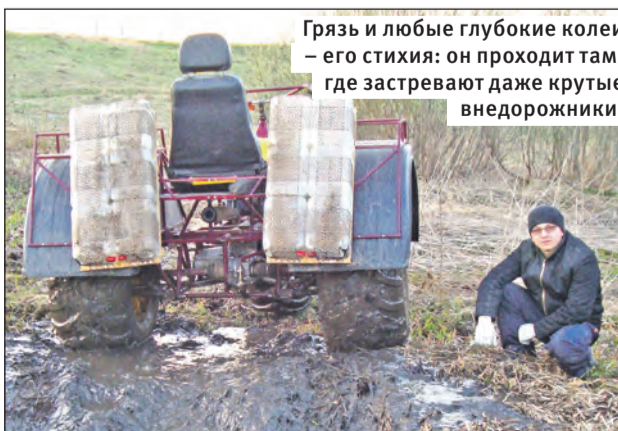
Езда по снегу на пневмоходе – как ходьба в снегоступах: площадь опоры большая, потому и не проваливаешься.
