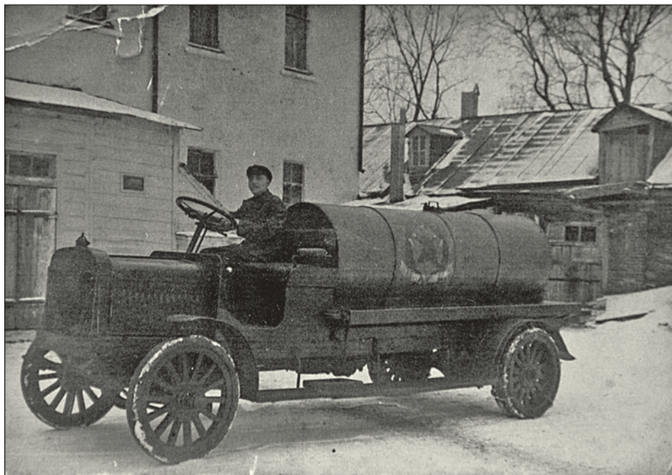
Тула, февраль 1925 года. Переоборудованный под пожарные нужды автомобиль «Гарнер» с цистерной ёмкостью 134 ведра. Водитель – Николай Гайдуков.
