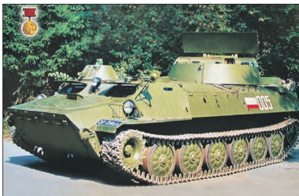
Мобильная РЛС наземной артиллерийской разведки «ШАР-10».
