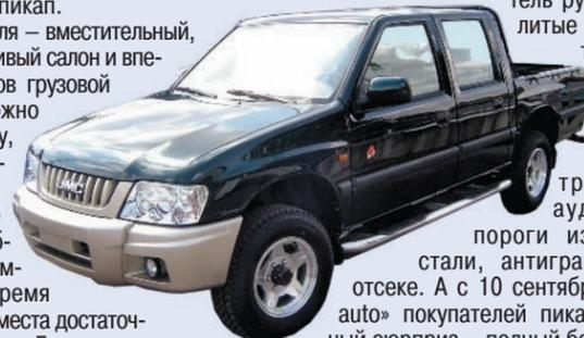
Автомобили JMC – это совместное производство компаний Jiahling Motors и ISUZU. Авто оснащено двигателем знаменитой марки ISUZU объемом 2,8 литра. Двигатель дизельный, а расход топлива для таких солидных габаритов и массы вполне экономичный – 7 л на 100 км.
