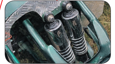
Весьма кстати пришлось стандартные амортизаторы от мотоцикла «Урал».
