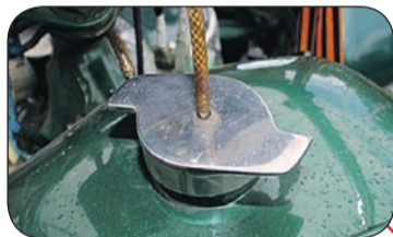
Крышка бензобака самодельная. Прообразом стала крышка от первых версий КамАЗа.
