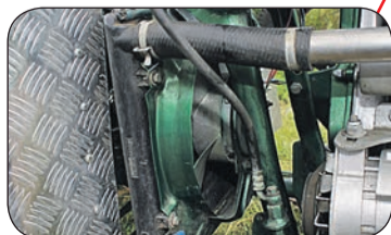
Охлаждение: вентилятор от «шестерки» и радиатор от «Оки».
