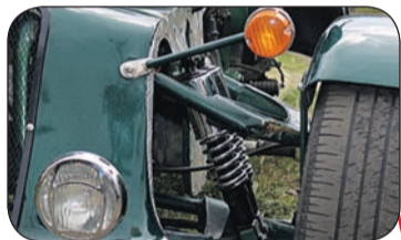
На трицикле установлены автомобильные противотуманки и поворотники от «Явы».
