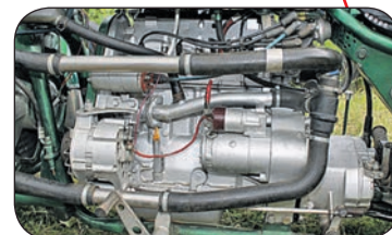
Сердце трайка – двигатель от «Таврии».
