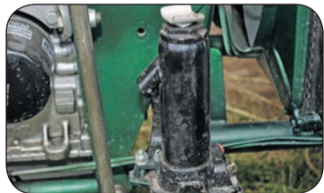
Трайк весит около 500 кг, поэтому нужен домкрат. Для него сделано специальное крепление.
