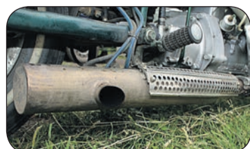
Глушитель сварен вручную, конструкция «подсмотрена» на авто.
