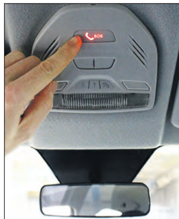
Новая LADA будет оборудована системой экстренного оповещения «ЭРА-ГЛОНАСС».
