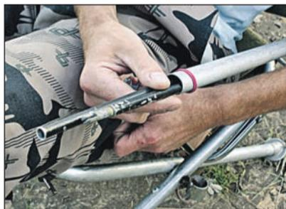
➤ Подлокотники стула крепятся к раме под углом и фиксируются под весом собственной тяжести. А в самом подлокотнике спрятаны опоры для столика, сделанные из армейской антенны.
