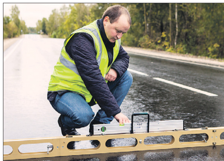
Куратор «Тулаупрадора» Александр Шерко замерил уклон асфальтобетонного покрытия на дороге Щекино-Водозабор. 24 промилле – это норма.
