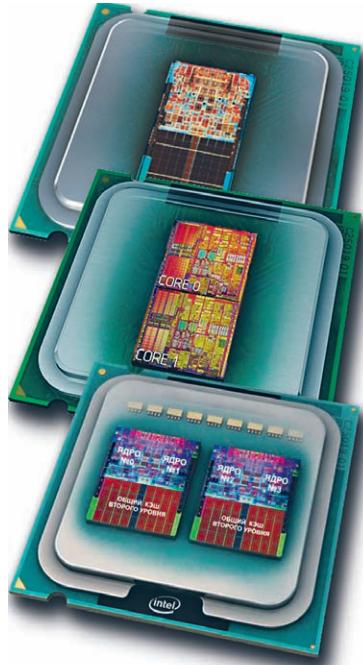
1-, 2- и 4-ядерный процессоры фирмы Intel в сравнении (сверху вниз).
