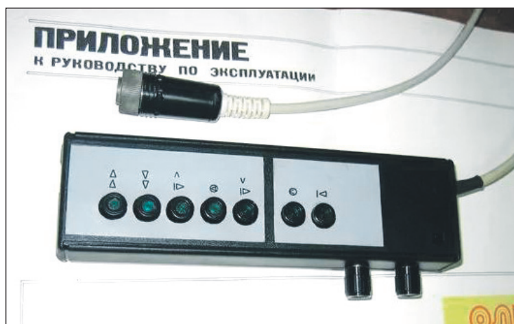
Проводное дистанционное управление магнитофона «Олимп».
