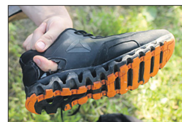
Дыра в кроссовке, через которую вышла часть разряда.
