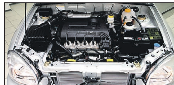
Chance оснащается экономичными моторами 1,3 или 1,5 л. Кузов у машины оцинкован.
