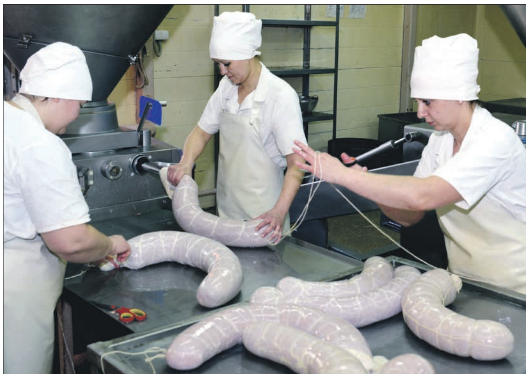
После наполнения натуральной оболочки фаршем каждый колбасный батон увязывают вручную прочным шпагатом.
