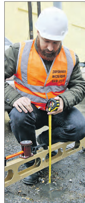
Глубина ямы на ул. Союзной 14 см. По ГОСТу можно только пять.
