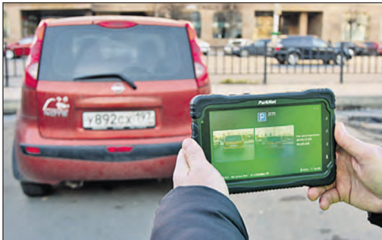
Система «ПаркНет» считывает номера машин и отправляет их фото на сервер.
