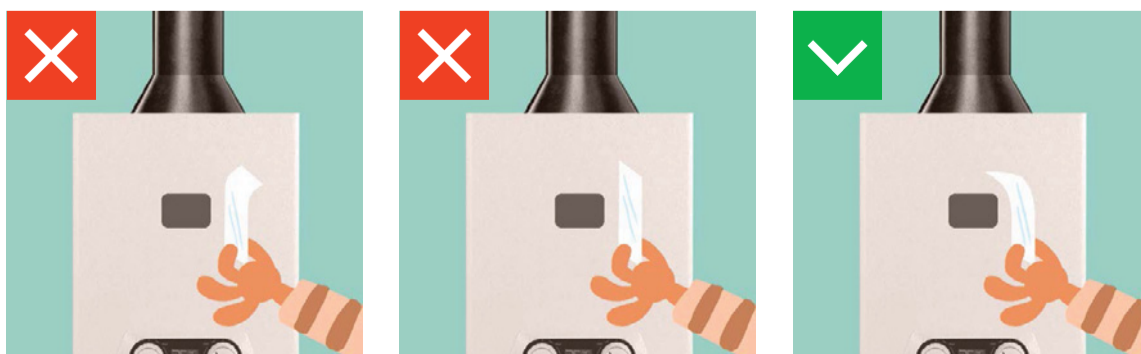
2. Для проверки тяги в дымовых каналах газовых колонок или котлов приложите тонкий лист бумаги к смотровому окну приборов. Если бумага притягивается, тяга есть.
