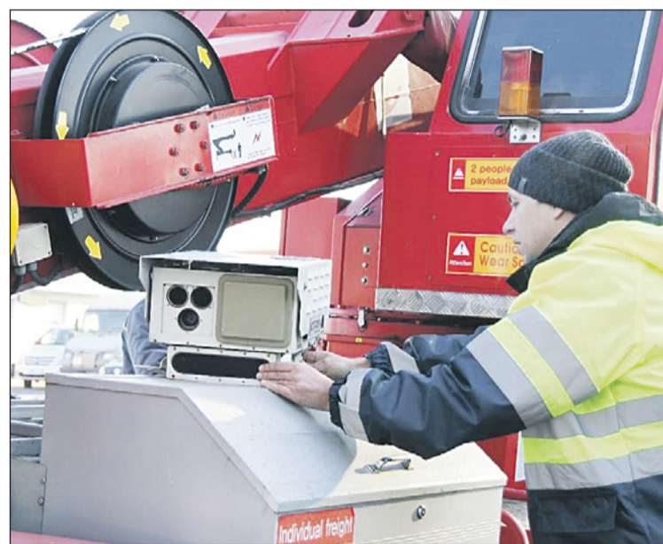
Комплекс «Кордон» имеет погрешность измерения скорости всего 1 км/ч, а рабочий диапазон фиксируемых скоростей – от 2 до 300 км/ч.
