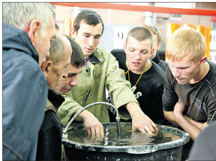
Проверка конкурсных работ по сварке: швы не должны пропускать воздух под давлением.
