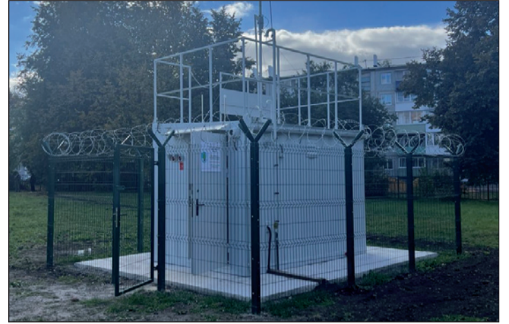
Современный стационарный пост для мониторинга воздуха в Новомосковске.
