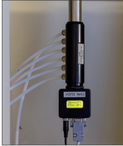
Специальный зонд для замеров воздуха.
