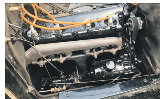
После механической обработки деталей двигателя, расточки и выполнения других необходимых работ, двигатель олдтаймера Ford Model T был собран и запущен.
