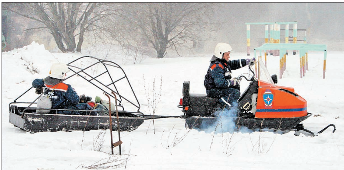
Эвакуировать «раненых» по глубокому снегу «эмчезники» приспособились на снегоходе «Бурани», оборудованном специальными санями.
