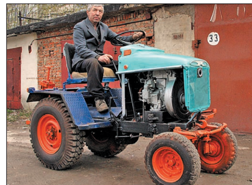
2008 год. Собрана самая удачная модификация «трактора Костерева» – Т-5М.
