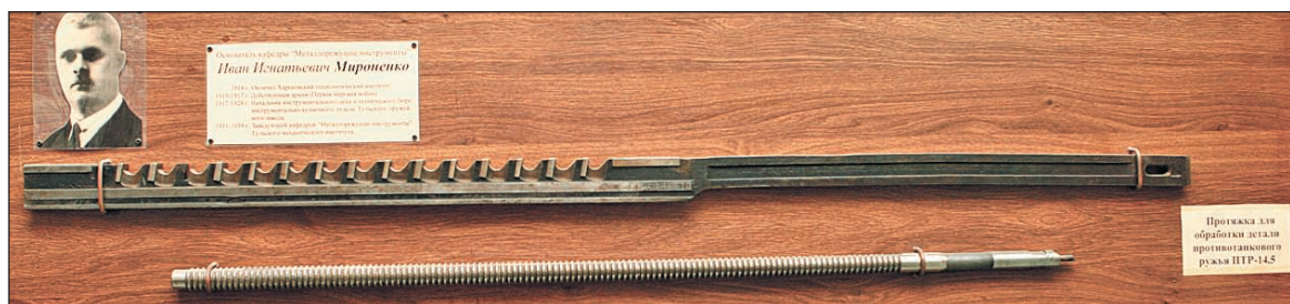
«Протажки» – инструмент для точной обработки отверстий в деталях противотанковых ружей 1941 года.
