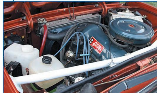
**МОТОР.** В штатный мотор автомобиля были установлены большие клапаны, новый распредвал и коленвал, а также карбюратор «Veber».
