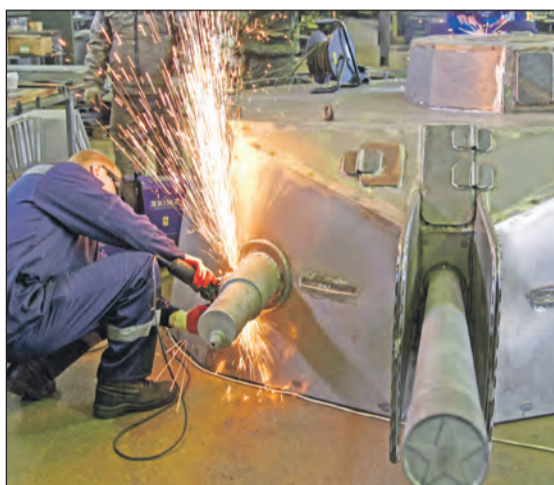
Паровоз бронепоезда «Туляк» «одевают» в «броню» в Узловском сервисном депо, а башню варят на Тульском машзаводе.
