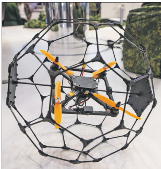
Беспилотный летательный аппарат «Муха», средний по размеру, предназначен для ведения разведки на открытой местности.
