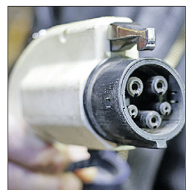
Заряжается «Электричка» от обычной розетки с помощью штатной вилки.
