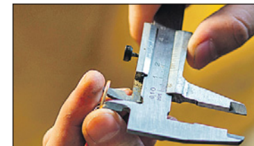
Полоска металла соединяется в кольцо припоем, обстукивание делает его идеально круглым. Размер проверяется кольцемером или штангенциркулем.
