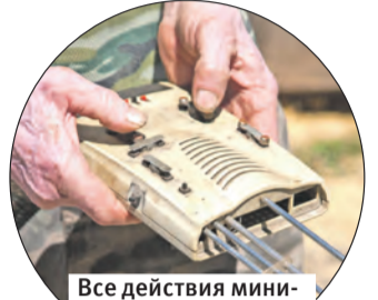
Все действия мини-бронемашин контролирует пульт управления, сделанный из старого интернет-модема.
