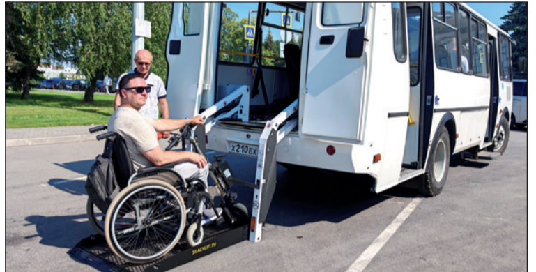
Подъемный механизм позволяет легко погрузить коляску с сидящим в ней человеком сразу в салон.
