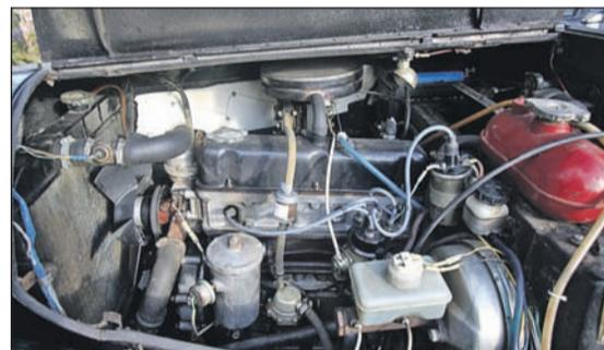
◀ Двигатель от 24-й «Волги» встал как влитой. «Пересадка сердца» добавила «бэхе» мощности. Кстати, новомосковский автомастер оснастил его дополнительным вентилятором.
