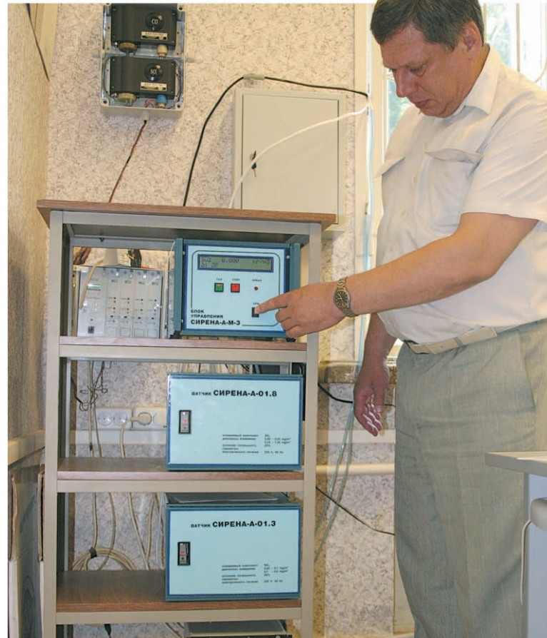
Экостанция, изобретенная профессором Панариным, легко помещается в автомобиль. С ее помощью можно определить, какими вредными веществами и в каком количестве загрязнен воздух.
