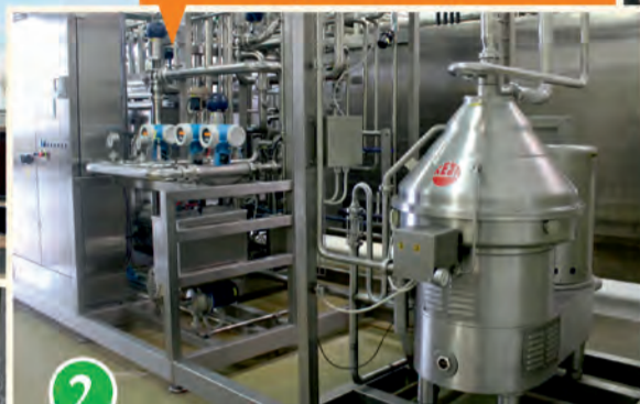
2 Отделение сливок от молока на сепараторе, их пастеризация, охлаждение и созревание.
